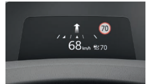
Head-up Display mit Verkehrszeichenerkennung
